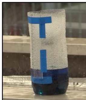
Figura 11 – Pluviômetro de garrafa PET Fonte: https://www.youtube.com/watch?v=XdVCuGnVDXc
