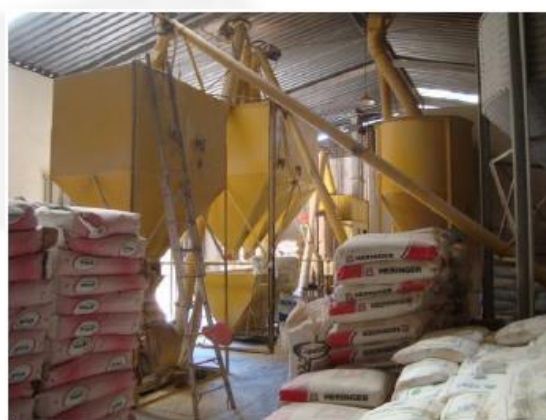
Foto 06. Print do relatório fotográfico acostado no processo - vista interna parcial da fábrica de rações mostrando silos pulmões, moinhos, misturador e uma área de armazenamento.
