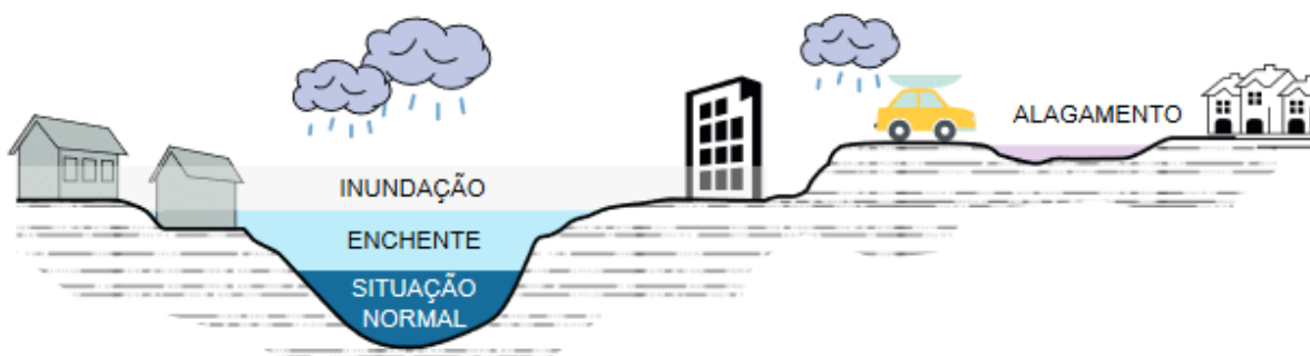
Figura 3.1 – Representação esquemática de fenômenos de alagamento, enchente e inundação
